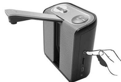
готовности. Теперь в верхней части устройства под регулятором громкости загорается индикатор питания и устройство ClearReader<sup>+</sup> готово к работе.
